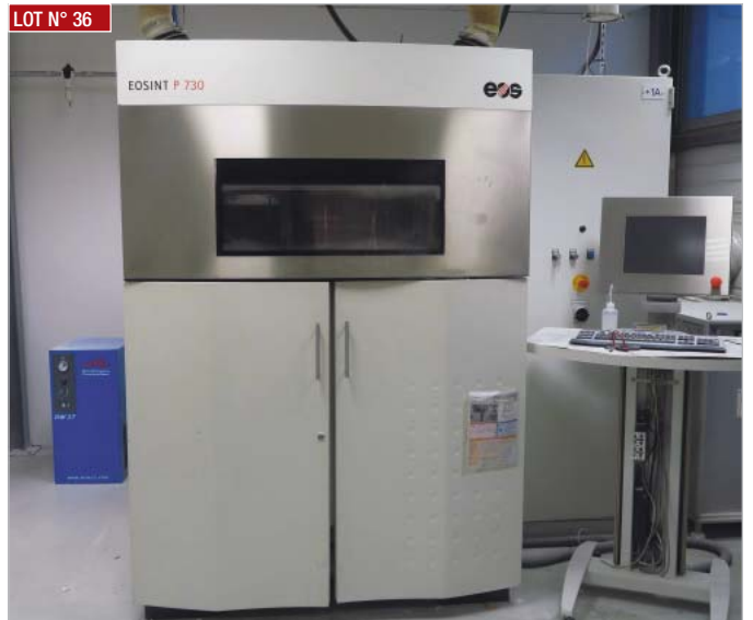
► Imprimante 3D EOS, process frittage de poudre plastique, mod. EOSINT P730, équipée de 2 trémies d'une cap. de 64 L, d'une pompe de remplissage, de 2 vis d'alimentation TRANSITUBE et divers accessoires ► 3D printer, EOS, plastic powder sintering process, mod. EOSINT P730, equipped with 2 hoppers having capacity of 64 L, filling pump, 2 TRANSITUBE feed tubes and various accessories
