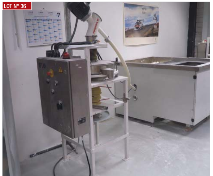
► Imprimante 3D EOS, process frittage de poudre plastique, mod. EOSINT P730, équipée de 2 trémies d'une cap. de 64 L, d'une pompe de remplissage, de 2 vis d'alimentation TRANSITUBE et divers accessoires ► 3D printer, EOS, plastic powder sintering process, mod. EOSINT P730, equipped with 2 hoppers having capacity of 64 L, filling pump, 2 TRANSITUBE feed tubes and various accessories
