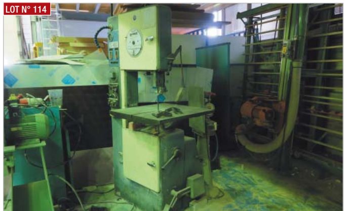
► Scie à ruban GUINOT, type S400, passage 400 mm avec soude lame ► Bandsaw, GUINOT, type S400, clear passage 400 mm with blade weld
