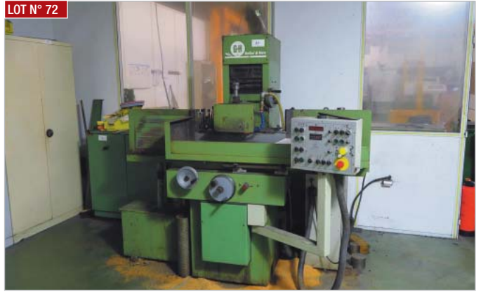
► Rectifieuse plane GEIBEL & HOTZ, modèle FS40AC (1996) ► GEIBEL & HOTZ flat grinder, model FS40AC (1996)
