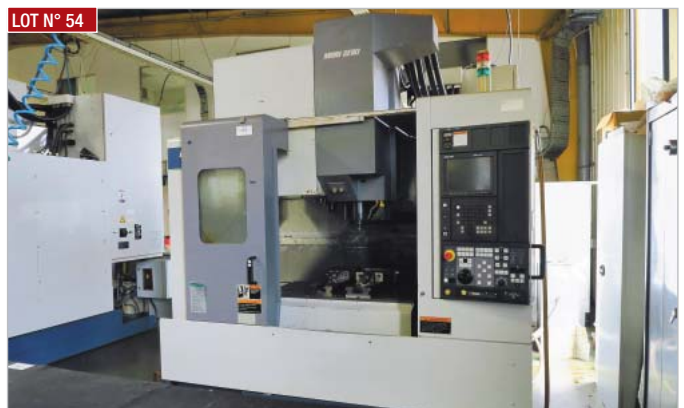
► Centre d'usinage MORI SEIKI, modèle SV500-40 (1999), tourelle 30 porte outils, CN MORI SEIKI MSC 501 ► MORI SEIKI machining center, model SV500-40 (1999), 30 toolholder turret, MORI SEIKI MSC-501 numerical control
