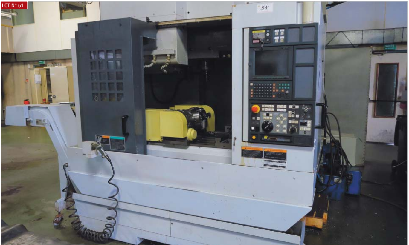
► Centre d'usinage MORI SEIKI, modèle NV5000A (2006), tourelle 30 porte outils, CN MORI SEIKI MSX-511 ► MORI SEIKI machining center, model NV5000A (2006), 30 toolholder turret, MORI SEIKI MSX-511 numerical control
