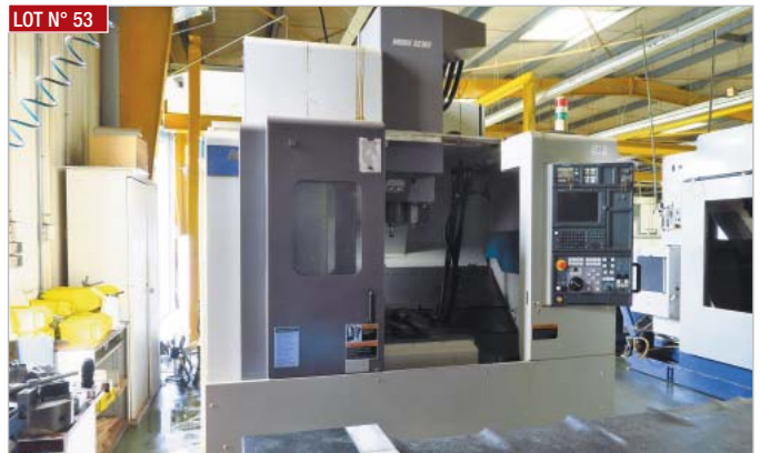
► Centre d'usinage MORI SEIKI, modèle SV503/40 (2002), tourelle 30 porte outils, CN MORI SEIKI MSC-502 ► MORI SEIKI machining center, model SV503/40 (2002), 30 toolholder turret, MORI SEIKI MSC-502 numerical control
