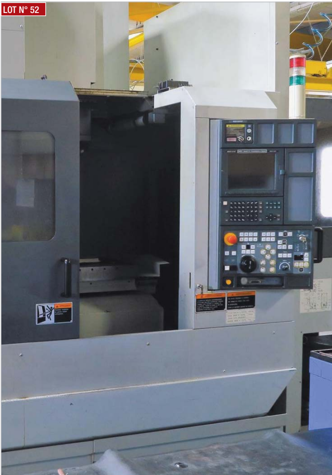
► Centre d'usinage MORI SEIKI, modèle NV 5000 (2003), tourelle 30 porte outils, CN MORI SEIKI MSC 501 ► MORI SEIKI machining center, model NV5000 (2003), 30 toolholder turret, MORI SEIKI MSC 501 numerical control
